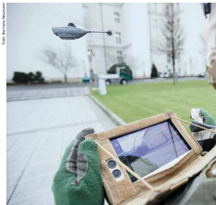
Das System der Black Hornet besteht aus jeweils den Drohnen, der Fernsteuerung und einem tragbaren Monitor zur Auswertung der Kameraaufnahmen.
