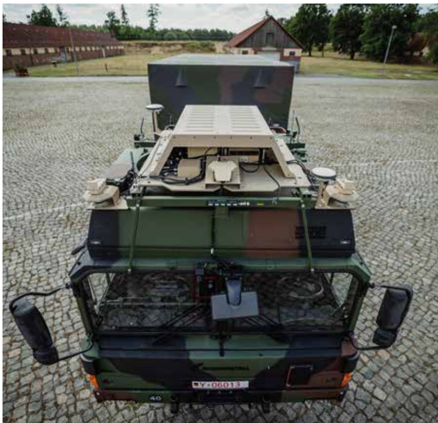
Das Autonomy-Kit ist auf dem Dach eines Lkw während des ersten Feldversuchs der sogenannten Elektronischen Deichsel im Rahmen des Projekts „Unbemanntes Fahren von Landsystemen in der Bundeswehr“ angebracht.
