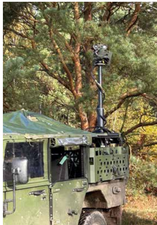
Das System mit NIGHTWOLF als Sensor auf einem Schwenk-Neigekopf und Teleskopmast.
