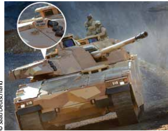
Laserwarnungssystem LEDS-50 als Sensoreinheit für Soft-/Hardkill Selbstschutzsysteme
