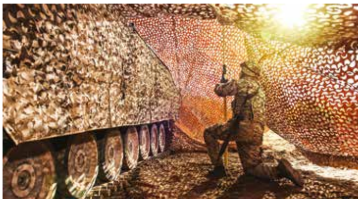
Multispektrale Tarnausstattung ULCAS (Ultra-Lightweight Camouflage Screen) in der Verwendung als Hochnetzarnung
