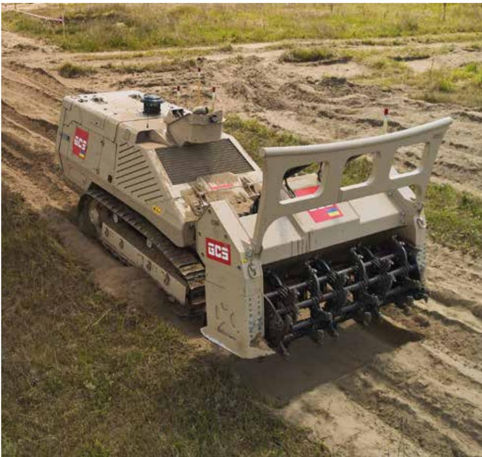
Minenräumplattform GCS-200 mit einer Minenfräse als Anbaugerät im Einsatz in der Ukraine
