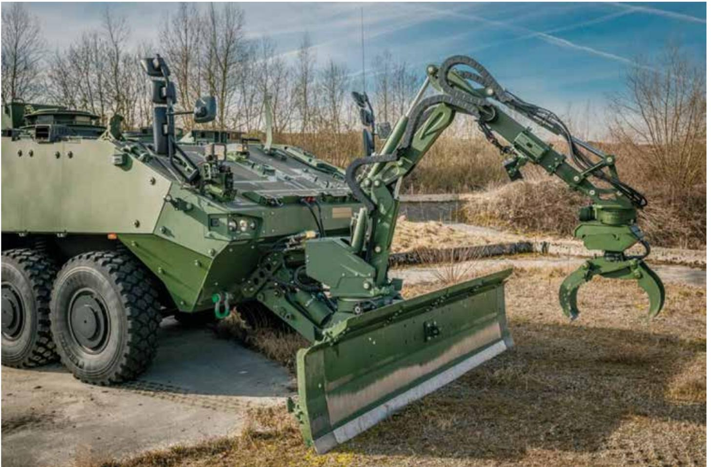
PIRANHA IV mit Schnellkupplungsadapter, Räumschild und Manipulator mit Kamerasystem
