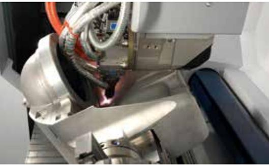
Fügen der Bauteilkomponenten mittels Laserschweißen
