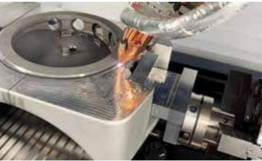
Laserschweißen auf der LMD-Anlage
