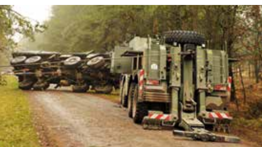
Berge- und Abschleppfahrzeug Bison mit TREIBMATIC Hauptbergewinde im Einsatz
