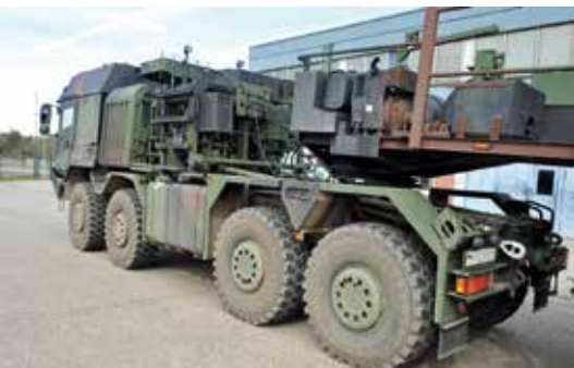
Schwerlasttransporter Mammuth mit TREIBMATIC Doppelwindenanlage
