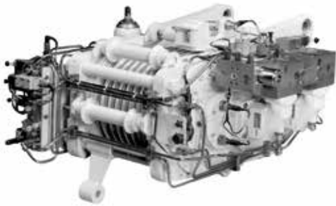
ROTZLER TREIBMATIC TR 650, eingesetzt im Bergepanzer Büffel
