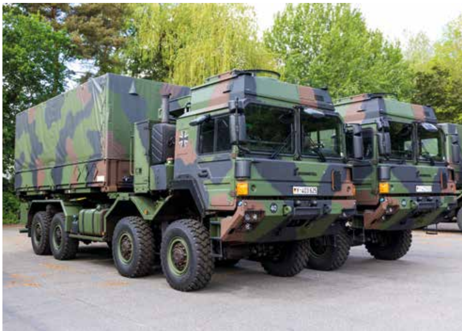
LKW 15 to UTF – als Pritschen- oder Container-Träger einsetzbar
