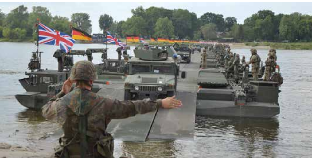
Britisch-deutscher Brückenschlag über die Weichsel während der Übung ANAKONDA 2016
