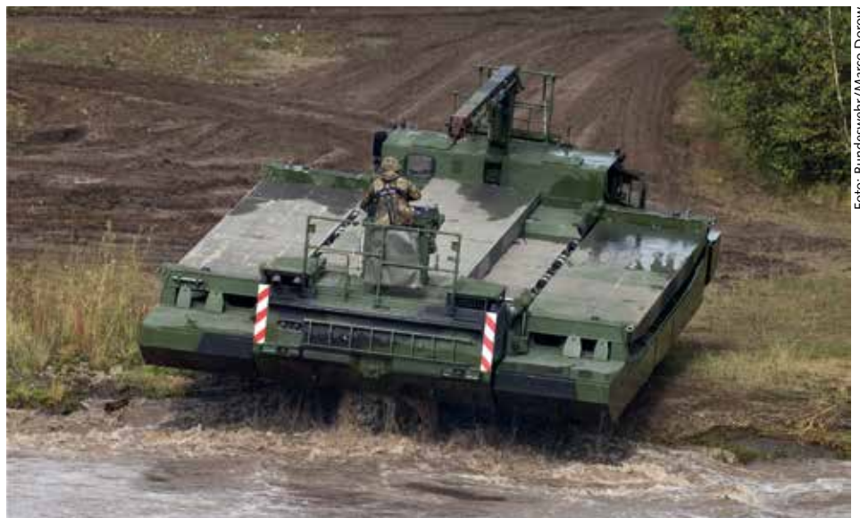
Die Schwimmschnellbrücke Amphibie M3 nach Übersetzen über ein Gewässer
