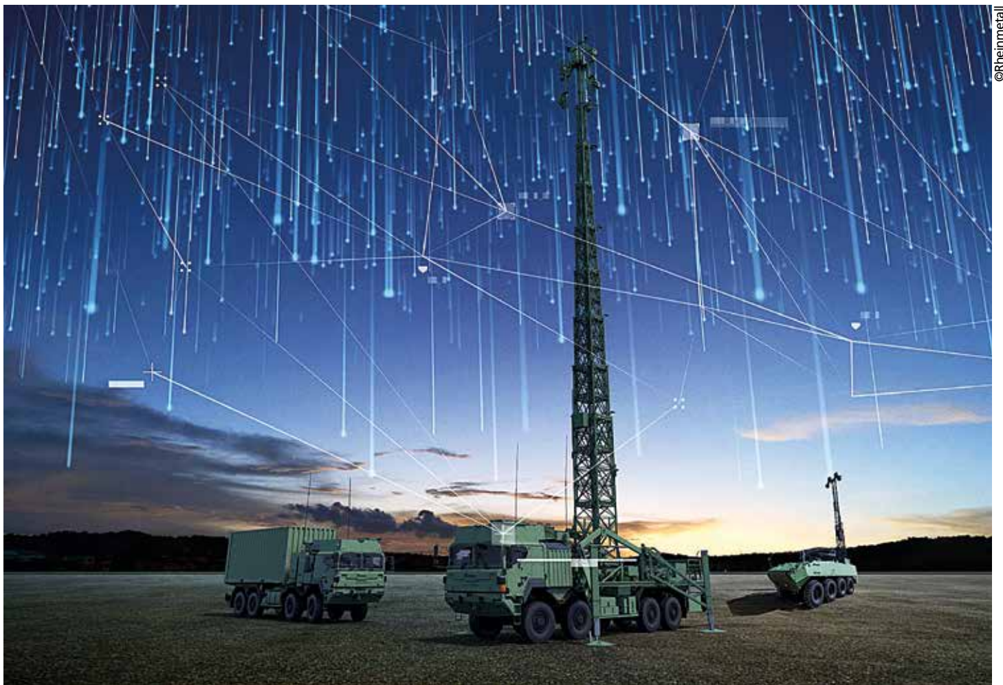
Das Richtfunknetz TaWAN wird auf geschützten Trägerfahrzeugen HX2 für die große und Piranha 8x8 für die kleine Komponente realisiert.
