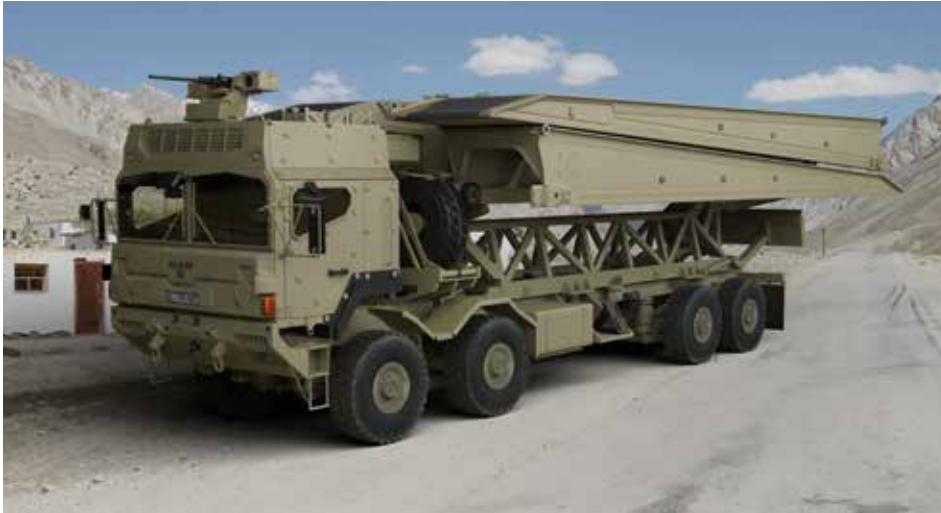
ANACONDA Konzept – Transport einer MLC 80+ BIBER Brücke auf einem 8x8 LKW
