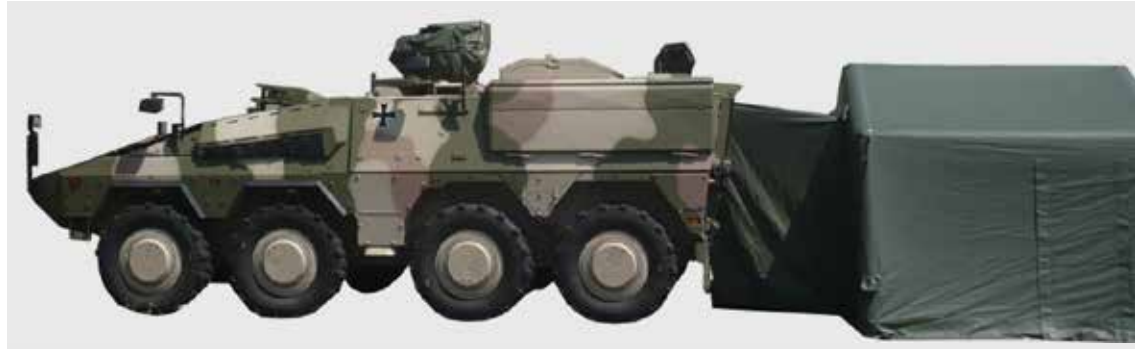
Das GTK Boxer Führungsfahrzeug mit Gefechtsstandzelt
