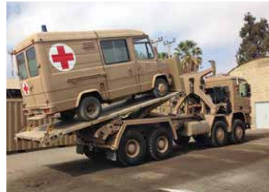
Wechselldesystem Scorpion mit STANAG-Flatrack im Einsatz in Arica/Chile
