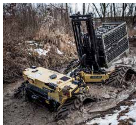
Crayler mit Gurtbandlaufwerk im schwierigen Geländeeinsatz
